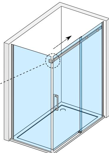
Nakon što smo vrata i fiksna stakla iznivelišali, pričvrstiti fiksna stakla za zidne profile samoreznim vijcima 4,2x13.
