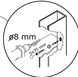
Odmaknite profil, izbušite rupe i postavite tiplove.
