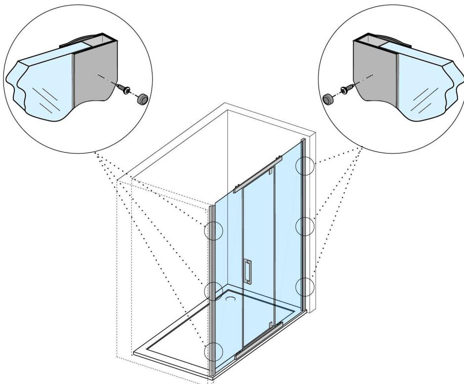
Nakon što su vrata iznivelišana, svi vezni elementi dotegnuti, potrebno je još pričvrstiti kabinu za zidne profile samoreznim vijcima 4,2x13.
