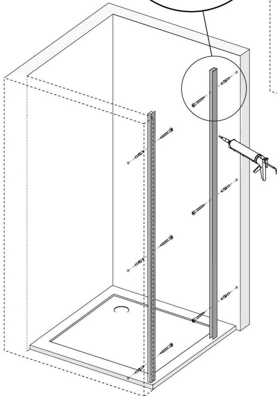
Odmaknite profile, izbušite rupe i postavite tiplove.
