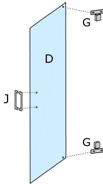
Postaviti vrata na nosače te ih pričvrstiti, nakon čega se mogu dotegnuti vijci na kraju nosača (H).
