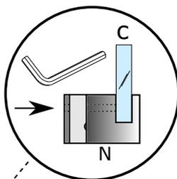
Na donjem uglu fiksnog stakla pričvrstiti element N za fiksno staklo (C), te ga dotegnuti pomoću imbus ključa.
