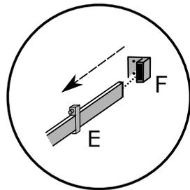
Stoper koji se nalazi na strani bliže zidu može biti pozicioniran ispred ili iza fiksatora stakla, zavisno od dimenzije kabine.
